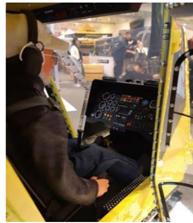
Das Cockpit bietet dem Piloten eine gute Sicht nach vorne und zu beiden Seiten des Cockpits. So kann er gut die Außenlast beobachten.
