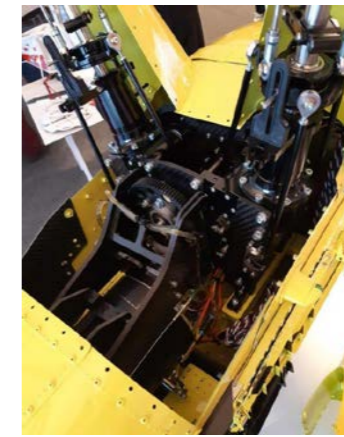
Für die Ansteuerung der beiden Taumelscheiben ist eine spezielle Mischerelektronik erforderlich.
